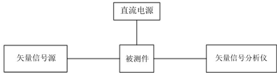
图 A.1 PA 性能测试典型连接示例
